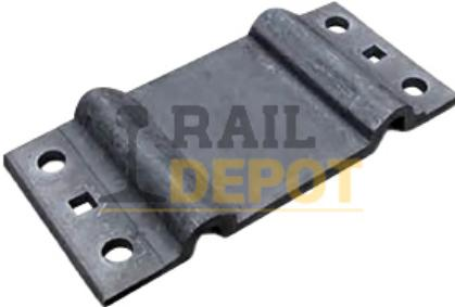
**Las Placas de Asiento de Riel Pandrol 6255** son componentes esenciales en sistemas de fijación elástica sobre durmiente de madera, diseñadas específicamente para asegurar el riel de 136 lbs mediante un patín de 6" a través de un clip E (no incluido).
