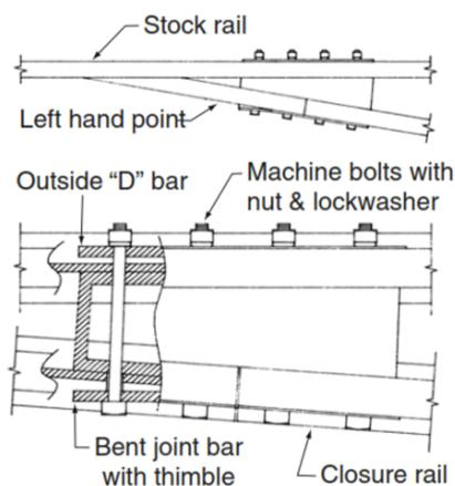
Introducimos el **Block Talón de Aguja**, una pieza esencial diseñada para sistemas ferroviarios que requieren la máxima precisión y durabilidad.
